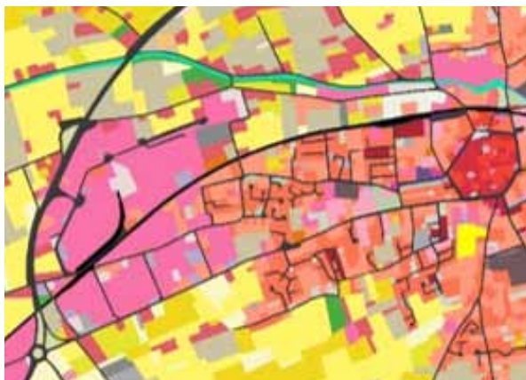
Le MOS Grande Echelle du SCoT du bassin de vie d'Avignon (Commune de Monteux) classifiée en 5 niveaux emboîtés avec 61 postes
